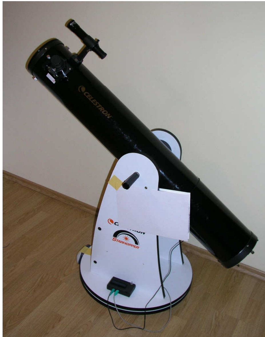
Obr.4 Snímač polohy zabudovaný u hvězdářského dalekohledu
